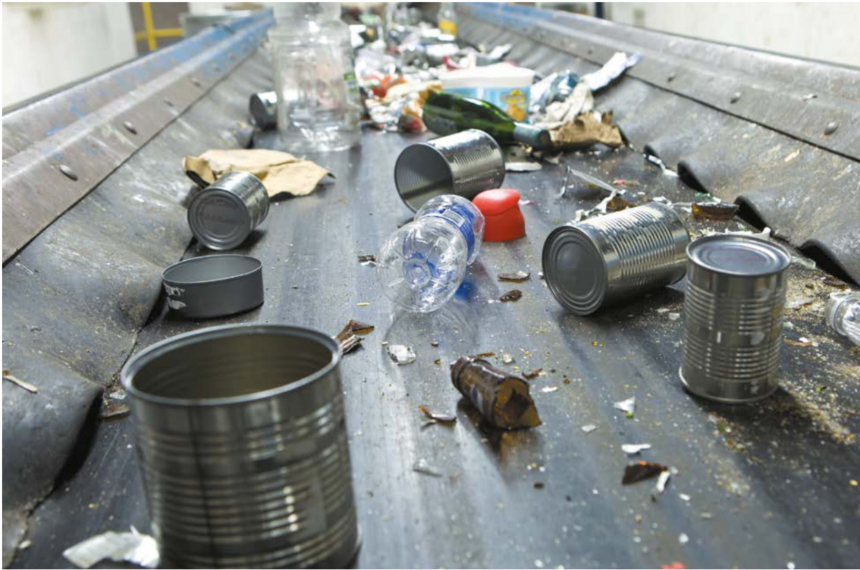
Correias transportadoras resistentes ao óleo em operação em uma indústria de reciclagem
